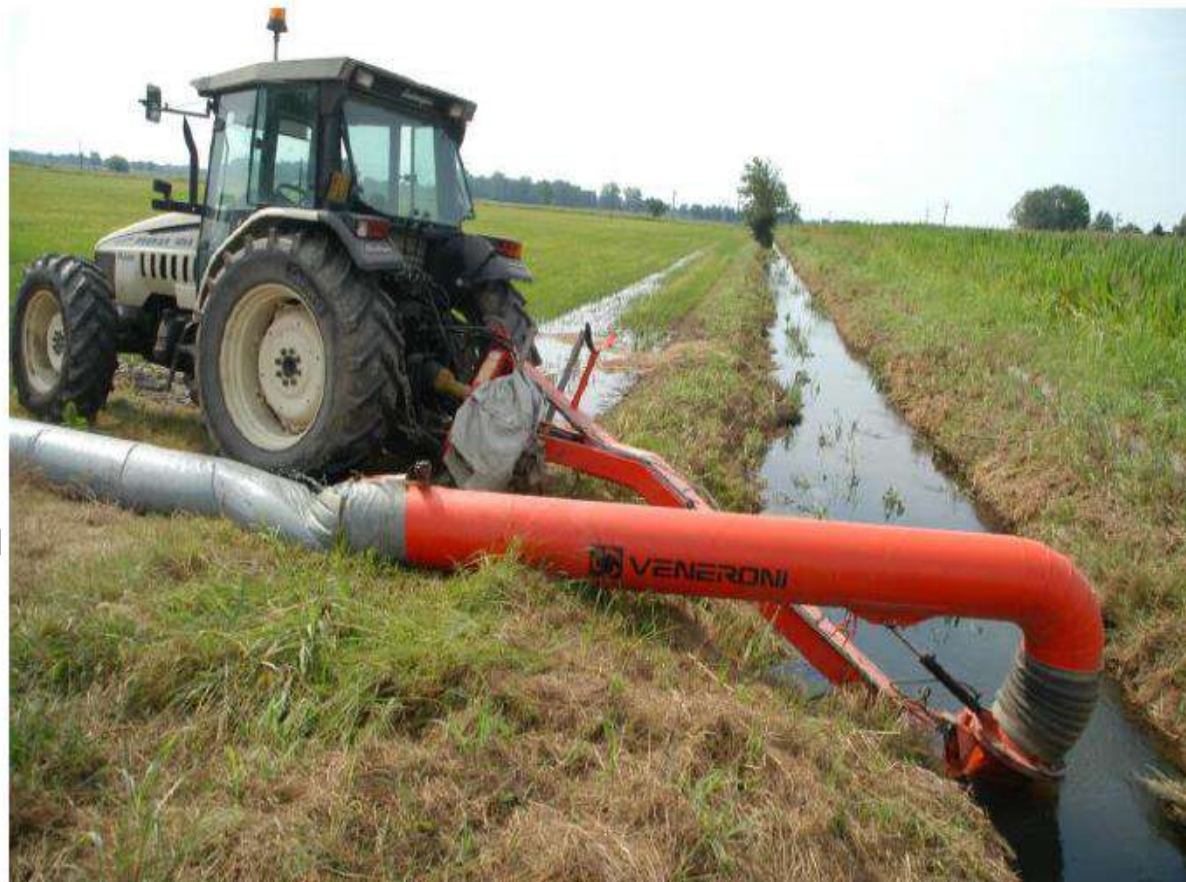
Figura 14. Pompaggio dell'acqua della Roggia Carnevala in un canale d'irrigazione secondario (Foto: Luca Gariboldi).
