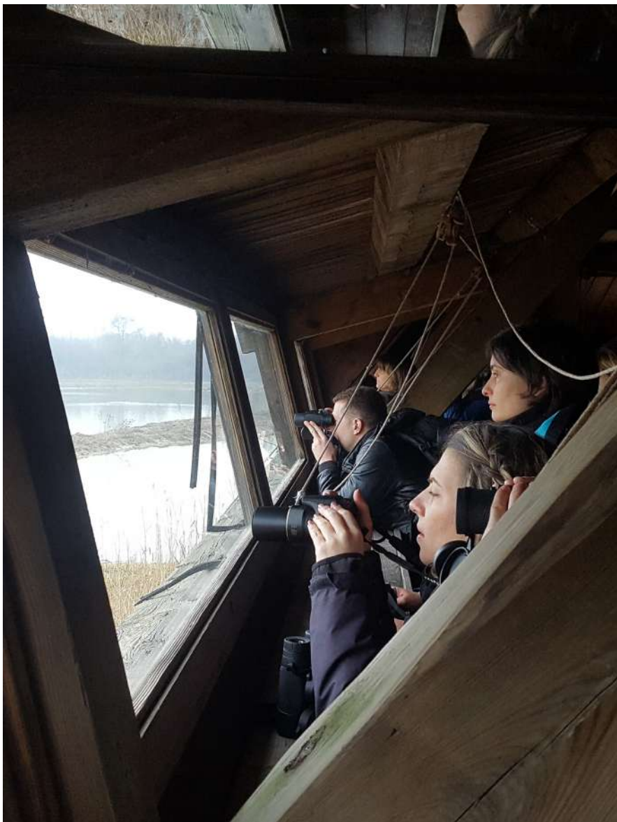
Riserva Naturale Regionale della Foce dell'Isonzo (GO) ZPS Foce dell'Isonzo - Isola della Cona Interno di una struttura di osservazione. I vetri inclinati verso l'esterno evitano che gli uccelli vi si possano riflettere e scontrare in volo. Inoltre, l'inclinazione riduce la necessità di pulizia del vetro.
