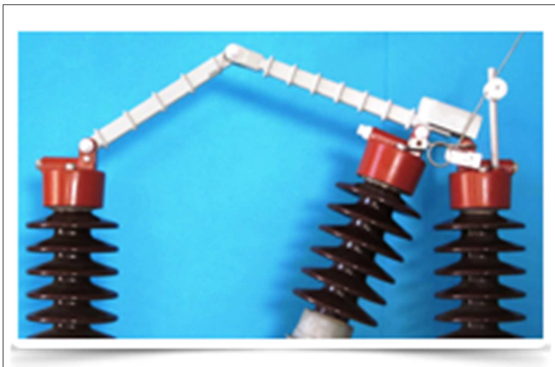
Figura - Kit di isolamento per sezionatori tripolari per esterno ideato e progettato da Improlax S.r.l. per favorire il ripristino delle condizioni di funzionamento delle reti di distribuzione in MT, consente di ridurre i guasti transitori o permanenti dovuti a contatti con uccelli evitandone la folgorazione. Da http://www.improlax.it/soluzioni.php
