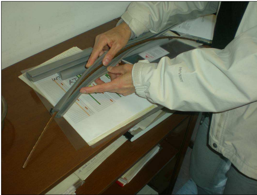
Figura - Profilo in gomma EPDM da applicare sui conduttori in tensione omologato da ENEL. Foto: E. Bassi.
