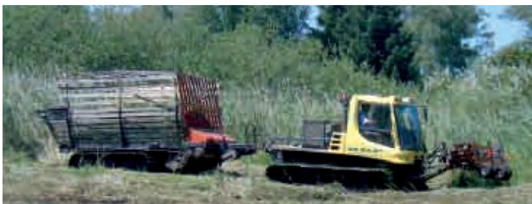
Figura 6. Esempio di macchinario ideale per lo sfalcio del canneto con rimozione dei resti. Battipista Kässbohrer Pisten Bully attrezzato con rimorchio raccoglitore cingolato e andanatrice dalla ditta NUP (Svizzera). Macchina andanatrice-raccoglitrice. (Foto D. Cuizzi)
