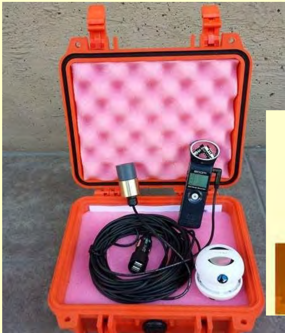
Idrofono Aquarian Audio con connettore XLR e 3 metri di cavo
